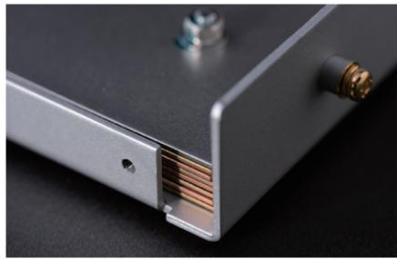
サンドブラスト加工による凹凸処理により、有効面積が60%アップ。約1,600 cm<sup>2</sup>(30cm×53.3cm)にまで拡大された。内部異金属積層プレートの構成は従来通りで、①ステンレス SUS/②黄銅/③銅/④黄銅/⑤銅/⑥黄銅/⑦銅/⑧黄銅の8層となっている
