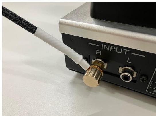
Fig. 17 RCA キャップによる GND 端子化
