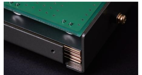
①ステンレス(SUS)／②黄銅／③銅／④黄銅／⑤銅／⑥黄銅／⑦銅／⑧黄銅の8層のレイヤー構造。ここにサンドブラスト加工をさらに高精度化させたファインブラスト加工を採用
