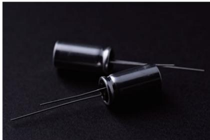
Crystal Ep シリーズで導入された特殊アルミ電解コンデンサを6基搭載。内部導体には帯状に加工された高純度アルミニウム箔を使用。導体表面を特殊エッチング処理することで、空洞が無数に形成され、導体表面積の拡大をもたらす。これにより1基あたり11,000cm<sup>2</sup>(110cm×100cm)という広大な有効面積を確保する
